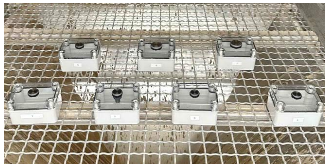
Fig. 2 Position DUT IP6KX.
