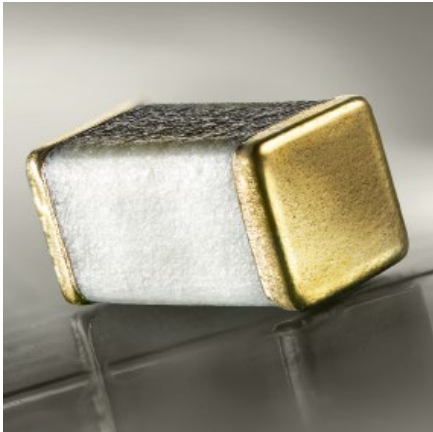
MGA-A: whisker- and dendrite-free
